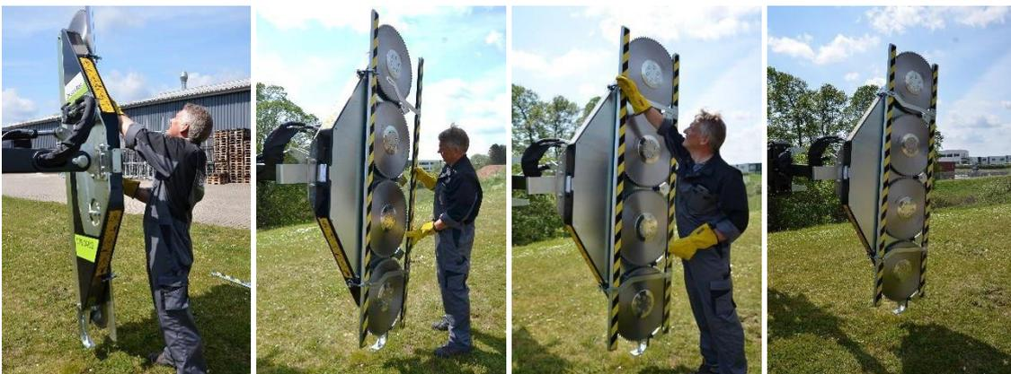
*D'abord il faut assembler le protecteur arrière et le fixer avec 2 séparateurs d'anneaux, puis le protecteur avant peut être monté et fixé avec 2 séparateurs d'anneaux.*
