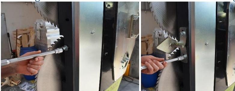
Démontez les 2 boulons et placez le guide de branche sous chaque lame de scie et serrez les boulons à la main.
