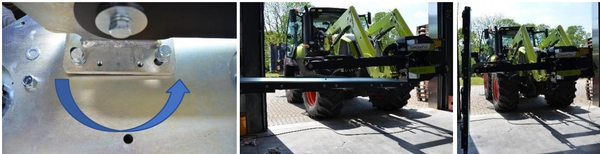
Avant de serrer, tournez la scie entière dans le sens inverse des aiguilles d'une montre. Les boulons doivent être serrés à 140 Nm.
