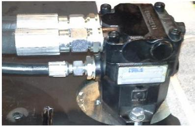
Monter les flexibles hydrauliques. Faites attention à la pression maximale admissible, en particulier sur le tuyau de drain et le tuyau de retour (le retour et le drain ne doivent pas être raccordés dans le même raccord de réservoir). Voir le manuel d'instructions..
