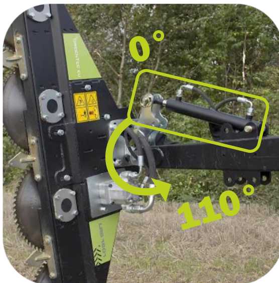
Réglage hydraulique de l'angle de travail : multiporteur HXF
