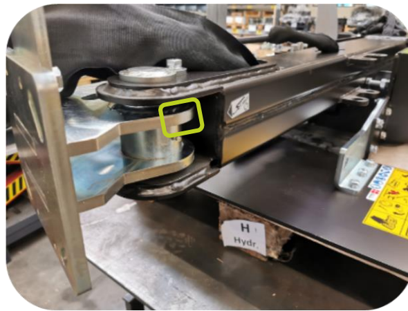
Graisseur sur le bras oscillant, au niveau du support de l'outil.
