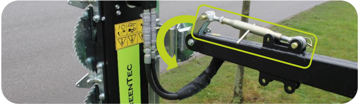
Multiporteur HXF avec ajustement mécanique de l'angle de travail via la biellette supérieure.
