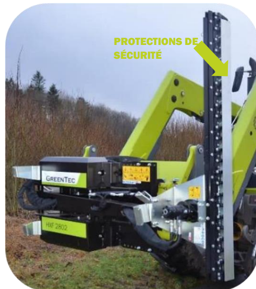
Multiporteur HXF monté avec sécateur HL en position de transport. L'outil est face à l'intérieur du véhicule, avec protections de sécurité sur les lames pour une sécurité maximale en circulation.
