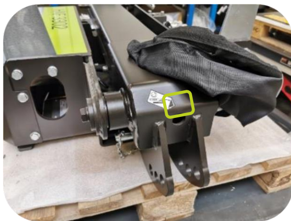
Graisseur à l'intérieur du bras mobile : multiporteur HXF
