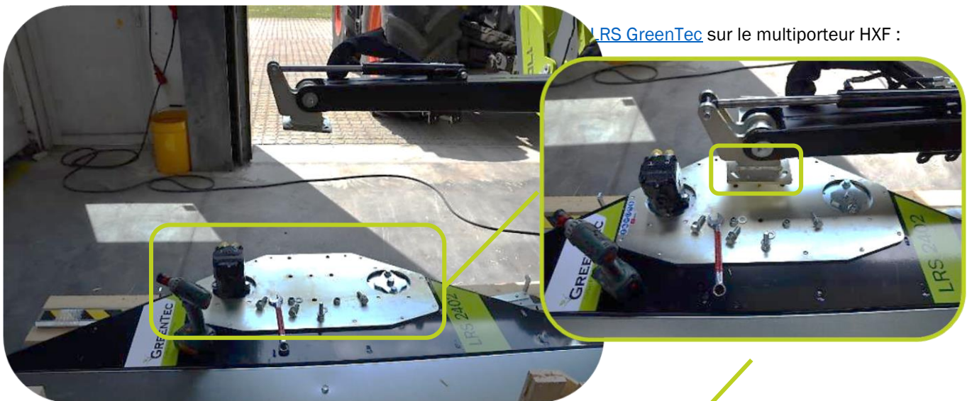
Support standard pour montage avec 4 boulons : multiporteur HXF.
