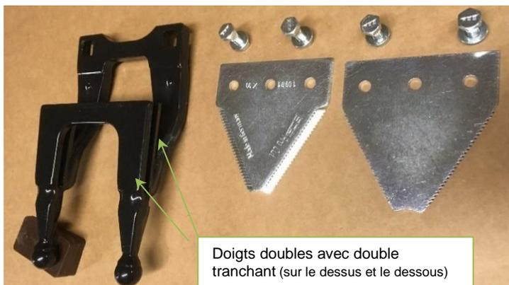
Doigts doubles avec double tranchant (sur le dessus et le dessous)
