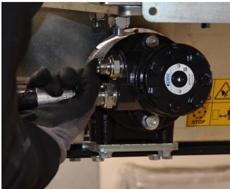
3 – 2 flexibles hydrauliques sont montés.
