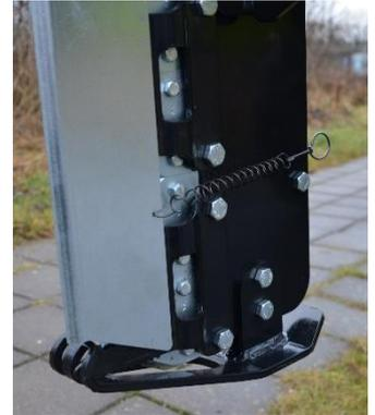
Figure 4 - Protecteur maintenu par 2 crochets
