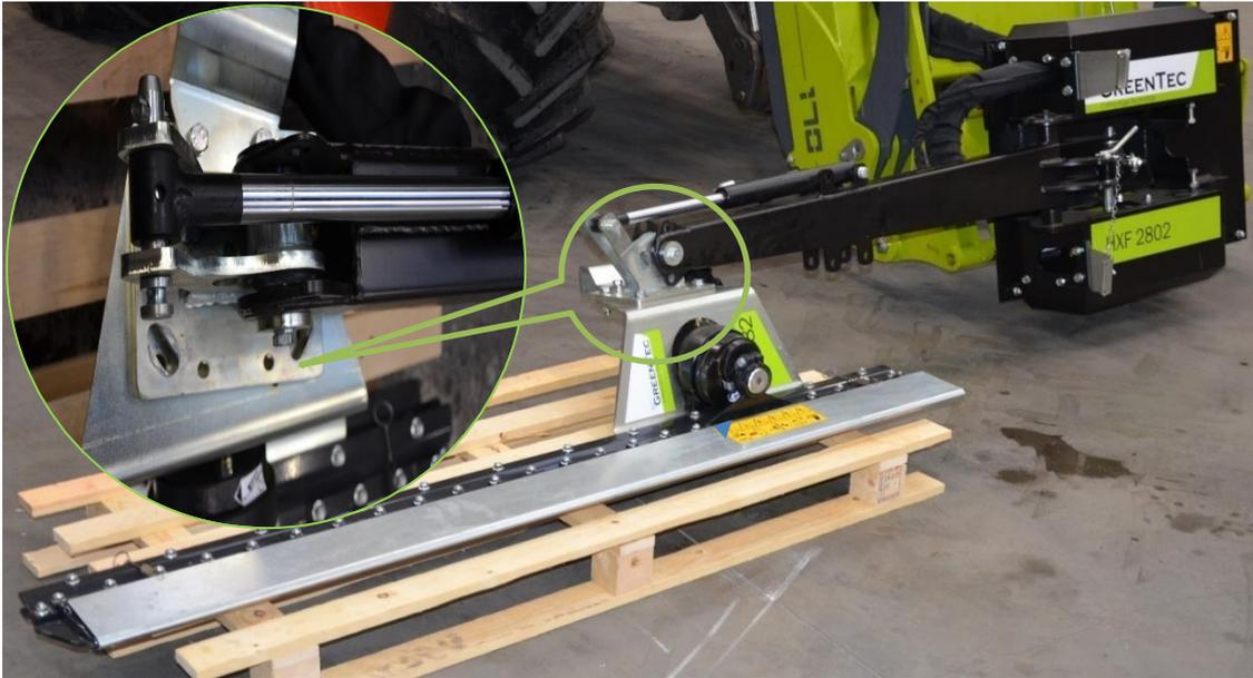
Figure 2 – Le sécateur est boulonné au châssis de l'appareil
