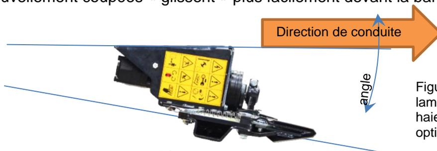
Figure 4 – La barre de lame est inclinée dans la haie pour une coupe optimale
