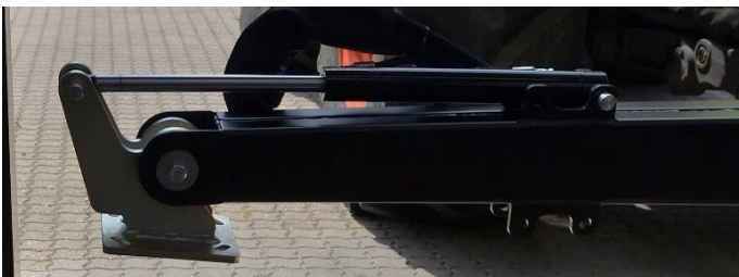
Faites tourner complètement le cylindre hydraulique pour le réglage de l'angle.
