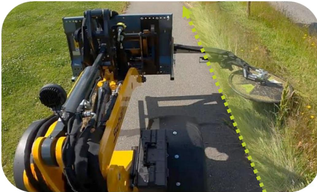
4. La hauteur de travail du porte-outil FOX peut être ajustée au moyen du chargeur frontal, en fonction du terrain/de la ligne de bordure.
