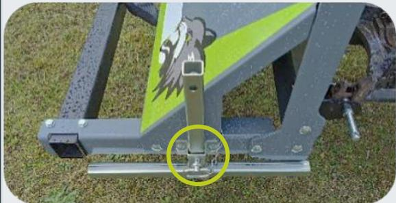
1. Ajuster et amener avec précaution le chargeur frontal du véhicule dans les supports pour chargeur du porte-outil FOX.
