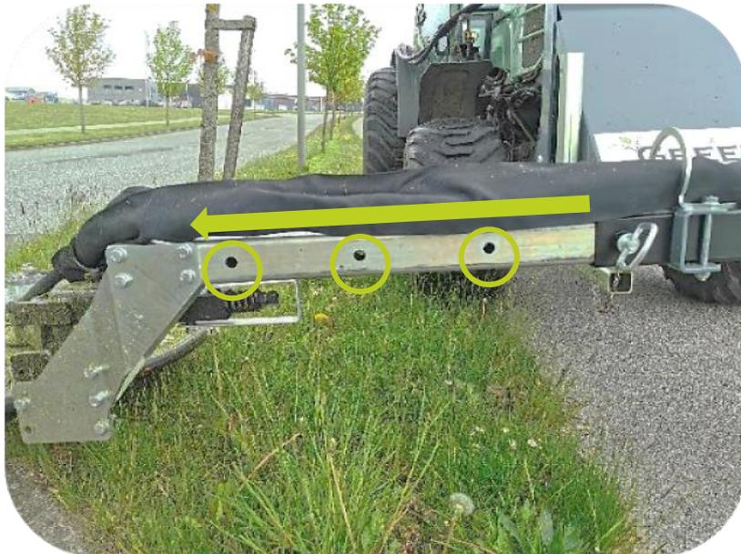
3. Le sens de déplacement avec l'outil ***doit être uniquement vers l'avant*** en suivant la « ligne de bordure » :
