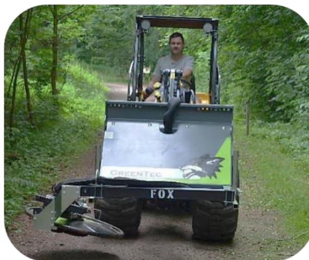
Porte-outil FOX avec faucheur sous clôture RI-80 en position de transport. Le faucheur sous clôture est orienté vers l'intérieur du véhicule, pour une sécurité maximale en conditions de circulation.
